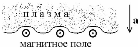
Рис. 4.16. Желобки на границе плазма – магнитное поле. Кружки с точками условно изображают силовые линии магнитного поля
